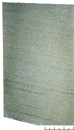
3д. Песчаник среднезернистый с крупной косою таблитчатой слоистостью
