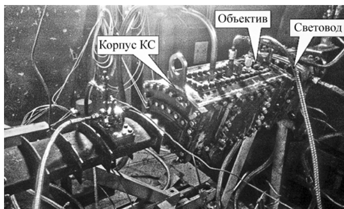
Рис. 7. Фотография одnogорелочного отсека с установленным объективом.
