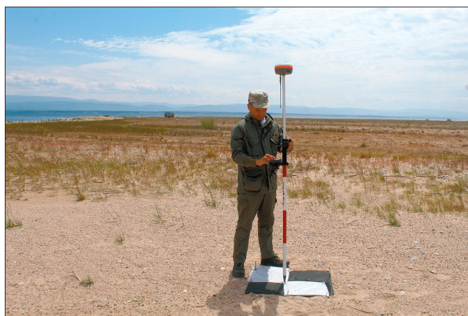
Рис. 1. Измерение координат опознака с помощью высокоточного ГНСС-приемника.
