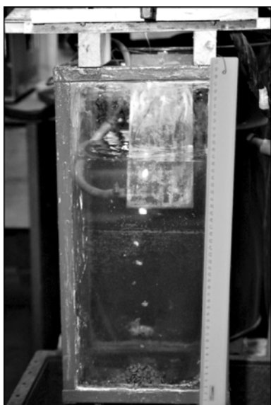
Рис. 5. Лабораторная установка для получения гранул.
