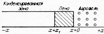
Рис. 1. Пространственное положение зон горения.
