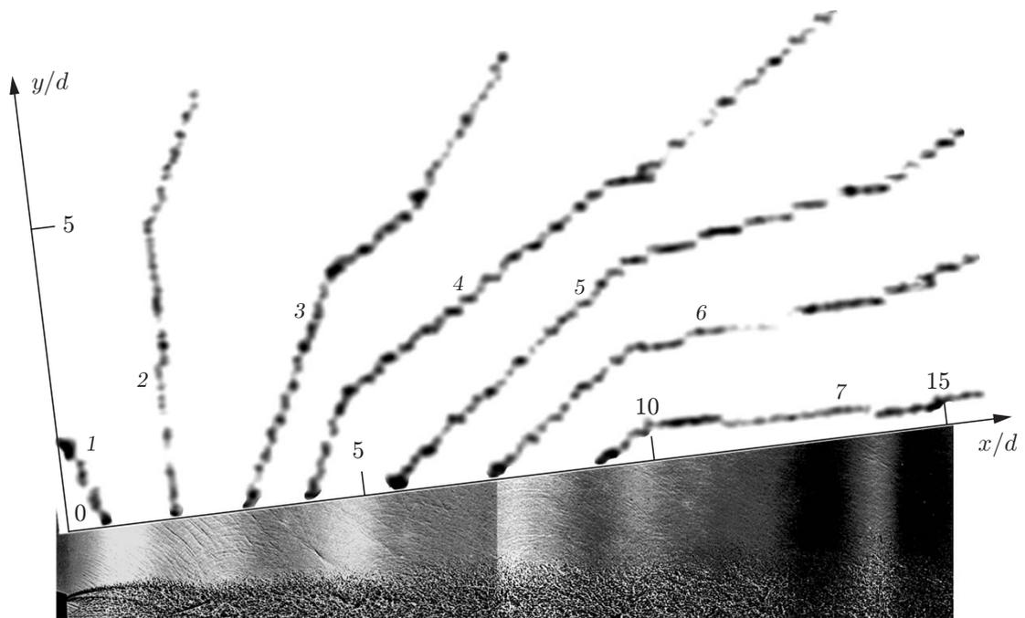
Рис. 4. Теневая фотография и изолинии звукового давления  $L$  при  $M = 2,0$ ,  $n = 2$ ,  $d = 10$  мм,  $Sh \approx 0,3$ :
