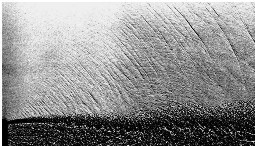
Рис. 5. Широкополосная составляющая ударного шума, излучаемая из области в конце первой ячейки периодической ударно-волновой структуры струи, при  $M = 2,5$ ,  $n = 1,0$ ,  $d = 20$  мм
