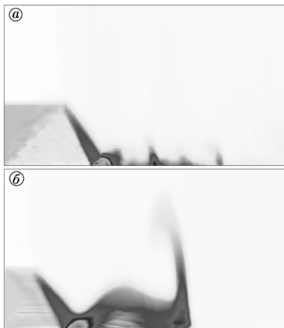
Рис. 13. Поля плотности при расчете без учета (а) и с учетом турбулентности (б) при M_s = 1,6 и m_2 = 0,0057
