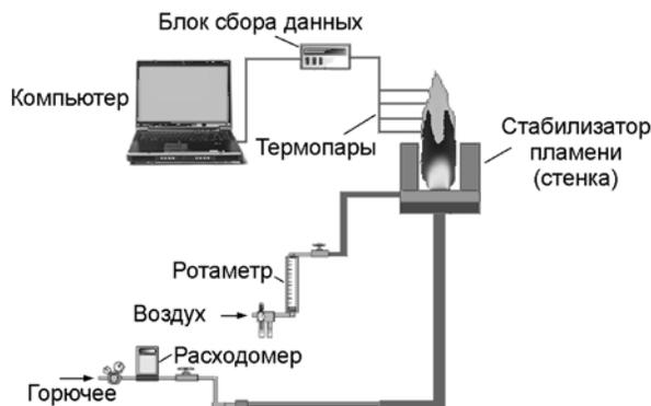
Рис. 1. Экспериментальная установка
