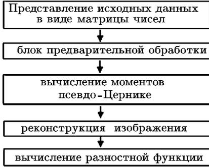
Рис. 2. Блок-схема алгоритма анализа изображений на основе моментов Цернике
