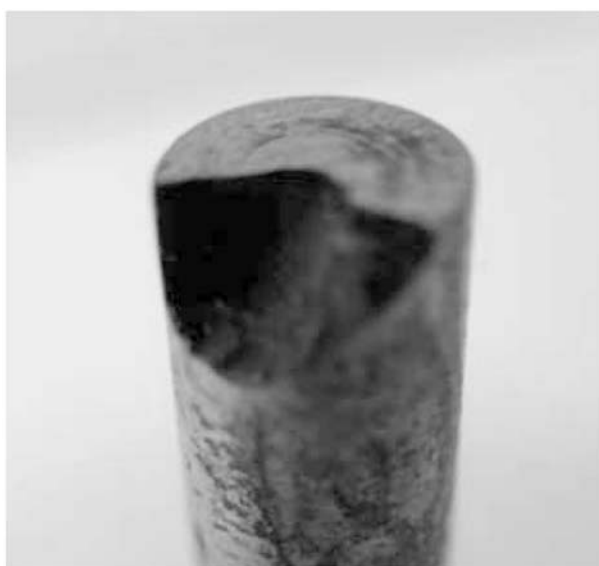
Фотография разрушенной части пуансона после взрыва навески ФТДО (масса навески 20 мг, диаметр пуансона 5 мм)
