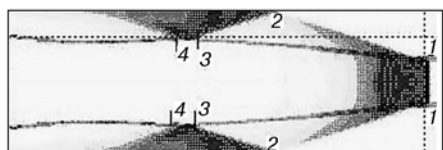
Рис. 3. Расчетная газодинамическая картина в модельном ВУ на момент подхода детонационного фронта к торцу заряда: \Delta = 3 мм, D = 4.13 км/с:
