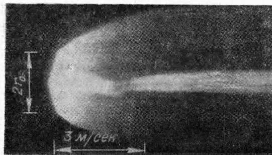
Рис. 2. Фоторазвертка сферической детонации смеси \text{CH}_4 + 2\text{O}_2 ( V_0 = 1,5 м 3 ; r_0 = 0,71 м), 2r_0 — начальный диаметр объема.
