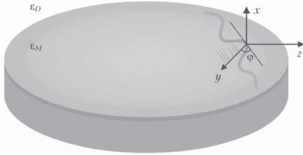
Рис. 2. Отражение ППП от границы деформированной области в слое металла: \varphi – угол между касательной к границе деформированной области и осью y
