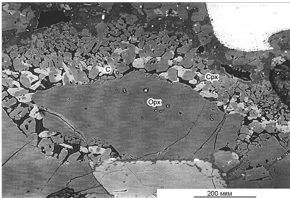
**Рис. 4. Фотография в отраженных электронах карбонатизированной метасоматической зоны.**
