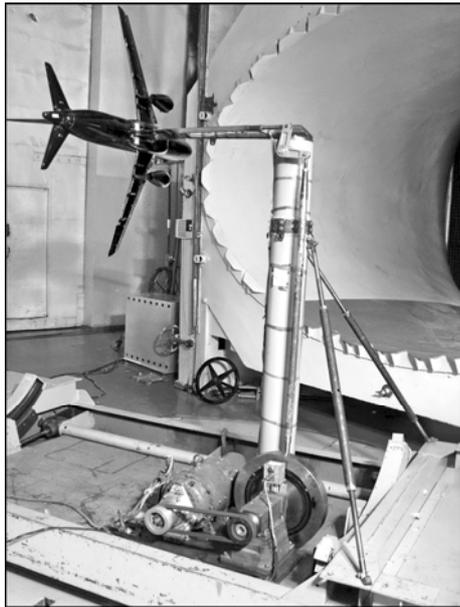
Перед началом испытаний производится настройка стенда в соответствии с заданной программой (установка среднего угла атаки, угла скольжения, частоты и амплитуды колебаний и т. д.). Далее в аэродинамической трубе набирается требуемая скорость потока, модели задаются гармонические колебания и производятся измерения.
