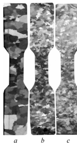
Рис. 1. Макроструктура сплава ЖС-6К с различным содержанием наномодификатора.
