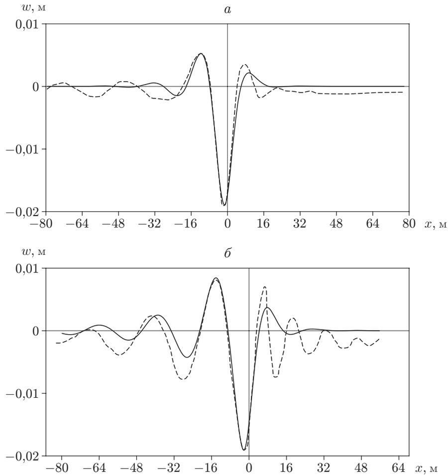
Рис. 3. Прогибы ледяной пластины при различных скоростях судна:
