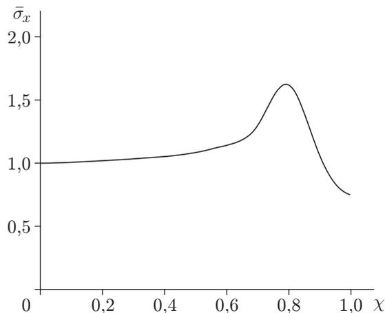
Рис. 2. Зависимость наибольших относительных напряжений в ледяном покрове от скорости нагрузки  $\chi = u/\sqrt{gH}$
