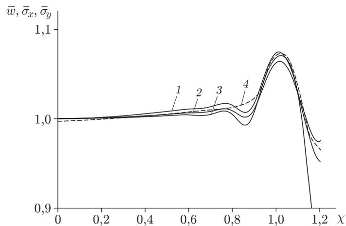
Рис. 4. Относительные прогибы  $\bar{w}$  и напряжения  $\bar{\sigma}_x, \bar{\sigma}_y$  в ледяном покрове:
