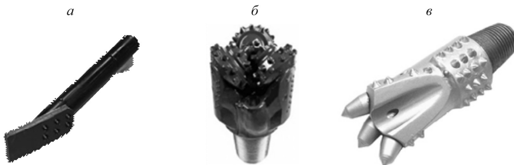
Рис. 1. Буровой инструмент: а — буровая лопатка ГНБ; б — шарошка; в — буровая лопатка для ударного бурения
