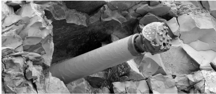
Рис. 2. Несимметричная буровая коронка с погружным пневмоударником
