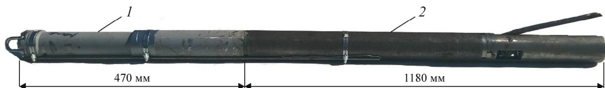
Рис. 1. Внешний вид скважинного вибрационного источника: 1 — дебалансный генератор упругих колебаний с пневматическим приводом; 2 — прижимное электромеханическое устройство
