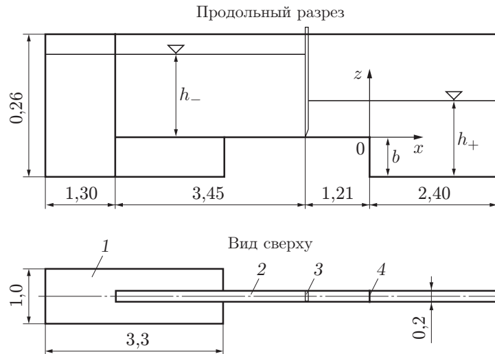
Рис. 1. Схема экспериментальной установки (размеры в м): 1 — бассейн; 2 — канал; 3 — плоский щит; 4 — уступ
