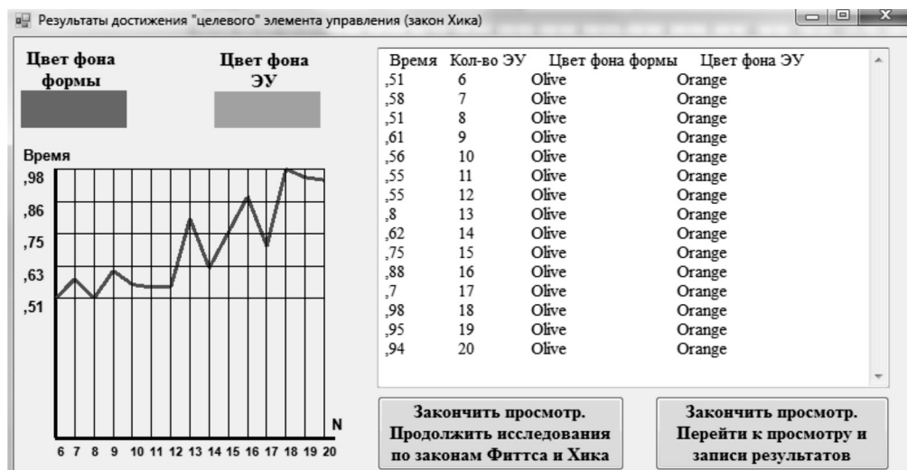
Рис. 8. Диалоговое окно с результатами испытаний по закону Хика в графическом и табличном виде (для комбинации цветов «Olive» и «Orange»)
