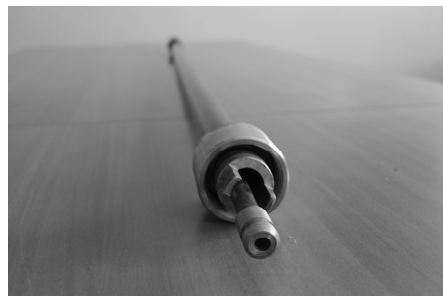
Рис. 3. Секция двухканального коаксиального трубопровода для шахтного гидроразрыва двухкомпонентными составами
