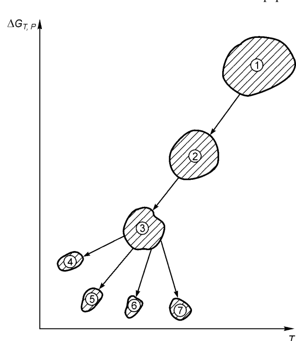
Рис. 2. Смена стационарных состояний гранитной системы в координатах \Delta G_{T,P}-T .
