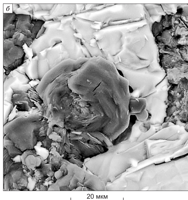
Рис. 4. Кристаллизация термодинамически нестабильного графита в форме сферул в силикатных расплавах с растворенным метастабильно пересыщенным углеродом при PT -параметрах стабильности алмаза (образцы после закалки).
