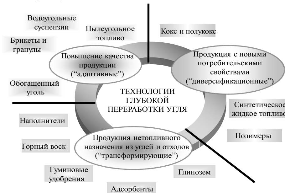
Рис. 1. Классификация технологий комплексной переработки углей (составлено по материалам [1])
