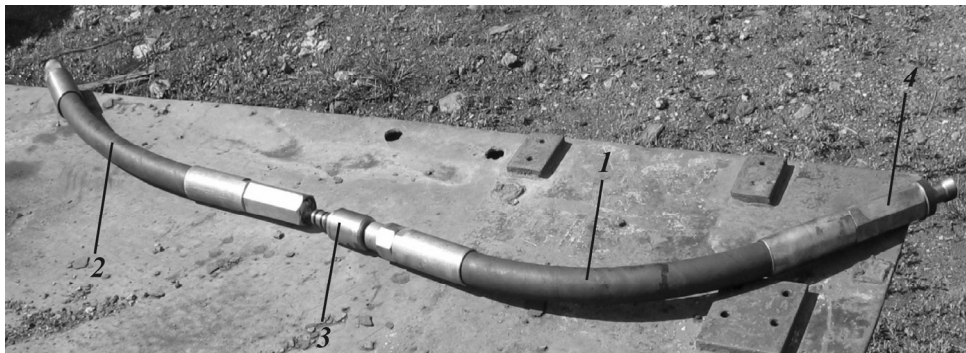
Рис. 9. Уравновешенный герметизатор УГ: 1, 2 — пакеры типа “Таурус”; 3 — клапанный синхронизатор КС-1; 4 — штуцер подвода рабочей жидкости от насоса
