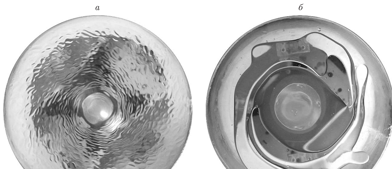
Рис. 4. Формы пятна подсолнечного масла на поверхности составного вихря ( R = 7,5 см): а — H = 0,2 м, \Omega = 5,2 с ^{-1} , V_k = 90 мл, Re = 480 ; б — H = 0,4 м, \Omega = 4,5 с ^{-1} , V_k = 150 мл, Re = 420
