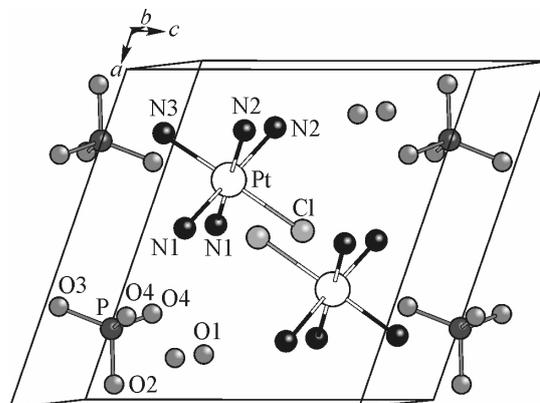
Кристаллическая структура  $[\text{Pt}(\text{NH}_3)_5\text{Cl}](\text{PO}_4) \cdot 2\text{H}_2\text{O}$ .
