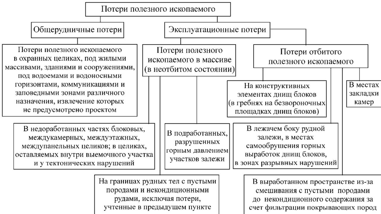
Рис. 20. Классификация потерь полезного ископаемого для условий рудников Горной Шории и Хакасии
