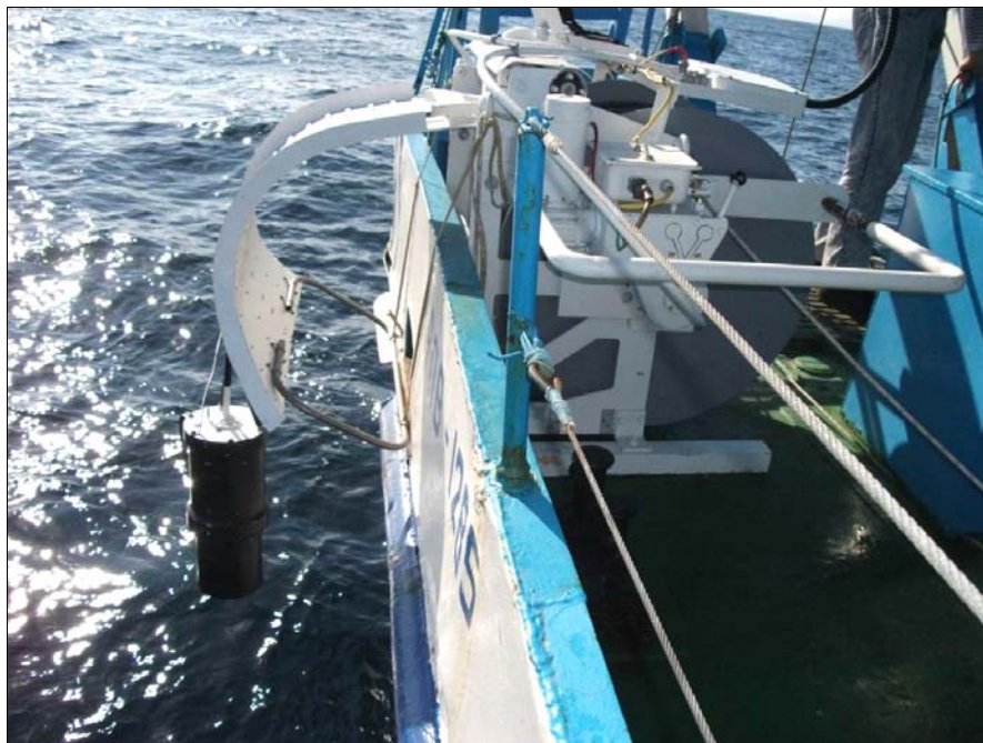
Рис. 2. Лебедка с погружаемым модулем на борту НИС «Импульс»
