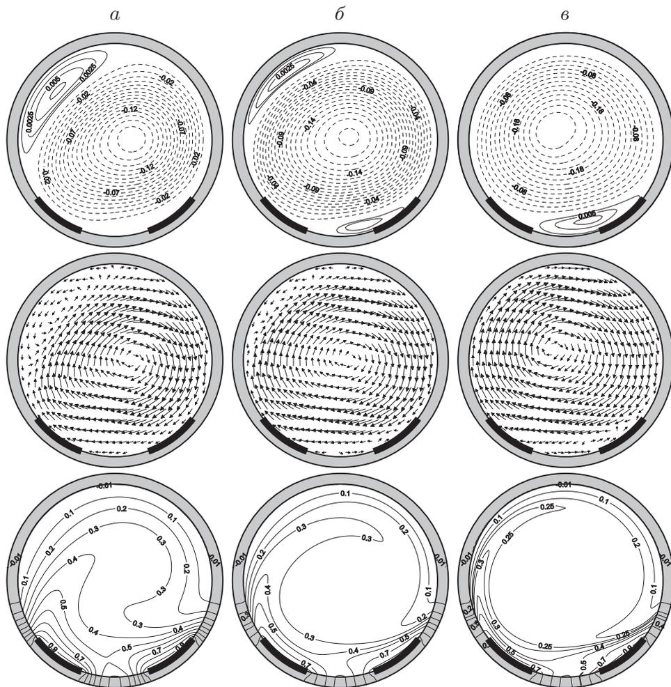
Рис. 5. Линии тока (вверху), поля скорости (посередине) и температуры (внизу) при  $\tau = 100$ ,  $Pr = 0,7$ ,  $\lambda_{2,1} = 5,7 \cdot 10^{-4}$ ,  $\Theta_2 = 1,0$ :
