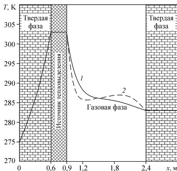
Рис. 6. Распределение температуры в сечении, проходящем по источнику тепловыделения,  $y = 0,9$  м.
