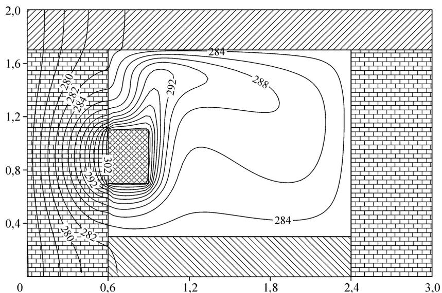
Рис. 4. Типичное поле температуры при  $Sh = 1$ ,  $Gr = 10^6$ ,  $Pr = 0,71$ .
