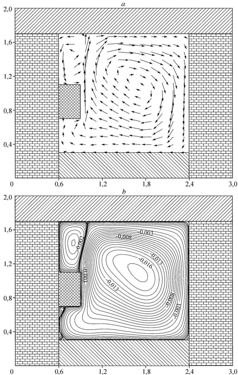
Рис. 2. Типичные поля скорости (a) и линии тока (b) при  $Sh = 1$ ,  $Gr = 10^6$ ,  $Pr = 0,71$ .
