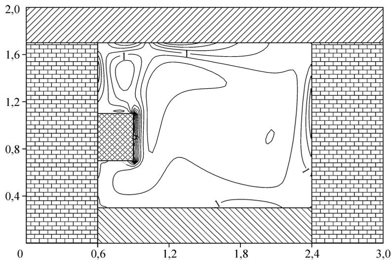
Рис. 3. Типичное поле вектора вихря при  $Sh = 1$ ,  $Gr = 10^6$ ,  $Pr = 0,71$ .
