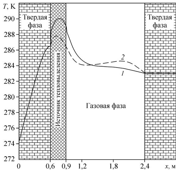
Рис. 5. Распределение температуры в сечении, проходящем под источником тепловыделения,  $y = 0,5$  м.
