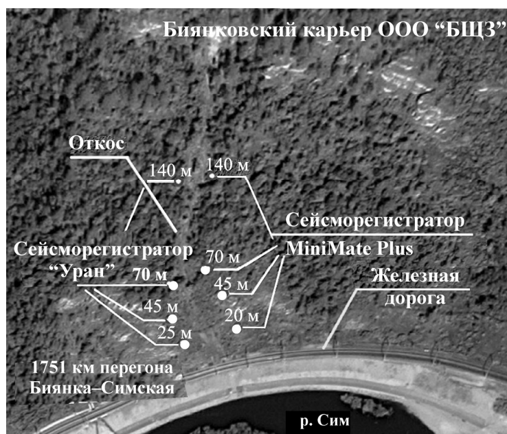
Рис. 2. Ситуационная схема с расположением сейсморегистраторов MiniMatePlus и "Уран" на нижнем участке склона (откоса) для регистрации сейсмических колебаний от проходящих железнодорожных составов на базах измерений 140, 70, 45, 25 и 20 м от железнодорожных полотна
