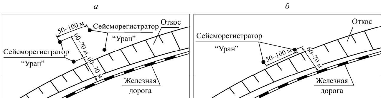
Рис. 1. Общая схема расстановки приборов для замеров воздействия на массив горных пород: а — от проходящих железнодорожных составов; б — от технологических взрывов на Биянковском карьере
