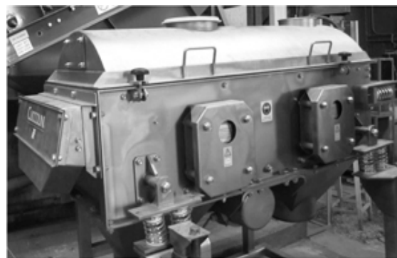
Рис. 3. Грохот ULSTM 1.5×0.6-E компании “Kroosh Technologies Ltd”
