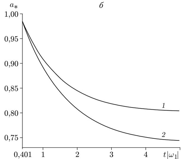
Рис. 4. Зависимость величины, обратной радиусу упругопластической границы, от времени при  $\eta_0 = 0,05$  и различных значениях скорости дилатансии и параметра упрочнения:
