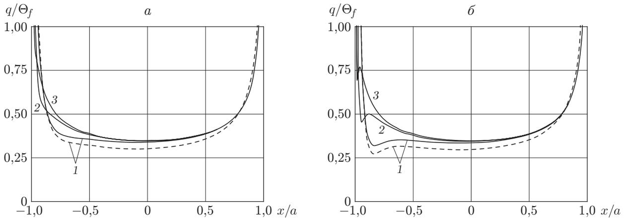
Распределения контактных давлений, полученные различными методами, при  $b = 2$  (а) и  $b = 3$  (б) в случае  $N_0 = 1$ :
