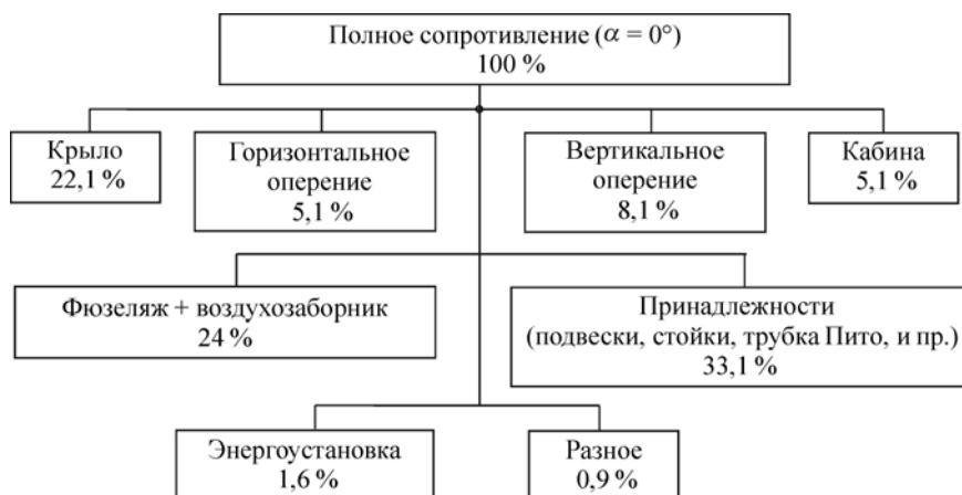
Рис. 1. Вклад в полное аэродинамическое сопротивление различных элементов ЛА (на примере дозвукового бомбардировщика). Компиляция из работы [1].
