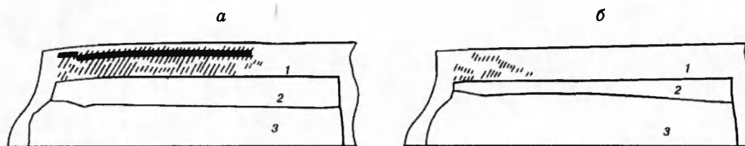
Рис. 4. Зоны повреждений для сплошной (а) и пористой прокладок (б): 1 — камера; 2 — прокладка; 3 — продукты детонации ВВ
