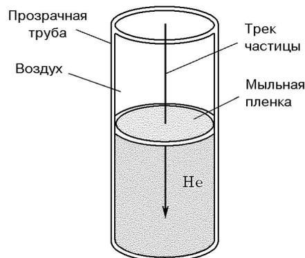
Рис. 4. Схема эксперимента для исследования динамики свечения частицы в процессе гашения в инертном газе после горения в воздухе в течение заданного промежутка времени
