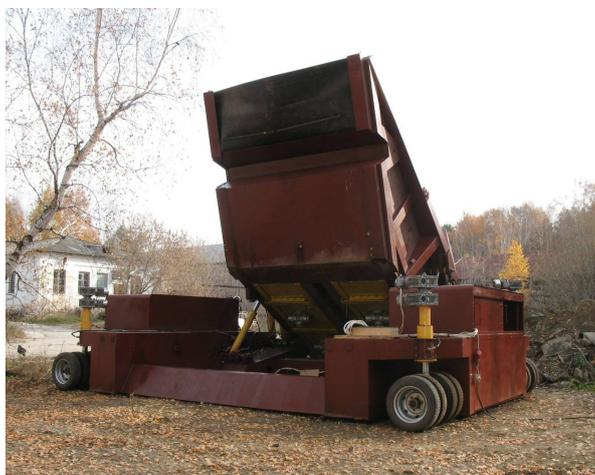
Рис. 3. Общий вид экспериментального вибрационного отвалообразователя
