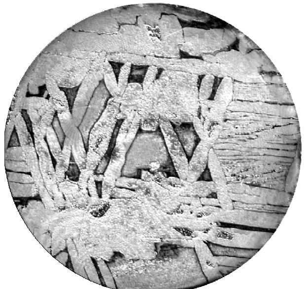
Рис. 2. Видманштеттеновая структура одного из срезов метеорита Чедер. Ув. \times 10 .
