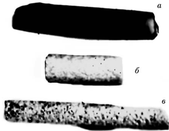
Рис. 1. Поверхность горения пороха Н (а) и пироксилинового пороха (б), предварительно уплотненного при p = 800 атм и T = 100 °С с плотности 1.49 до 1.59 г/см 3 (в — тот же порошок плотностью 1.49 г/см 3 )
