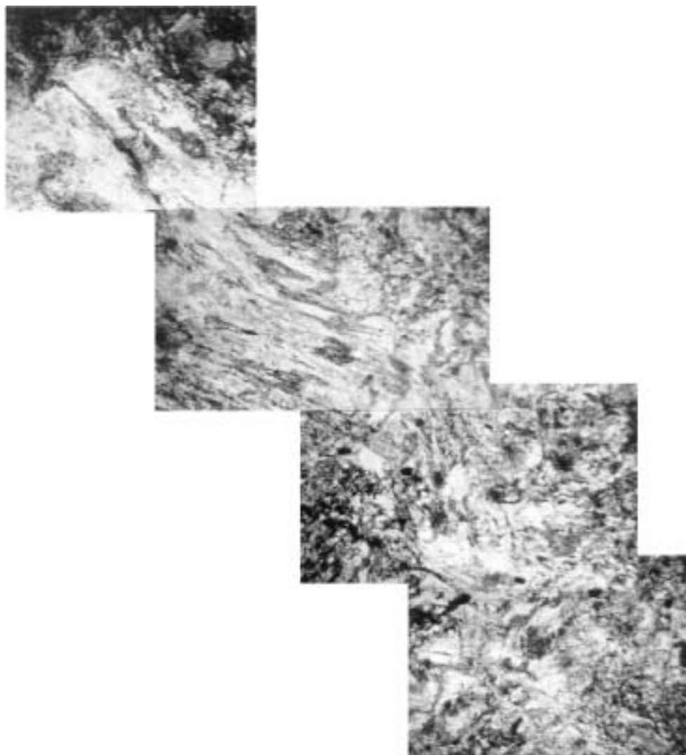
Рис. 3. Тонкая структура стали 12X18H10T, \times 12\,000
