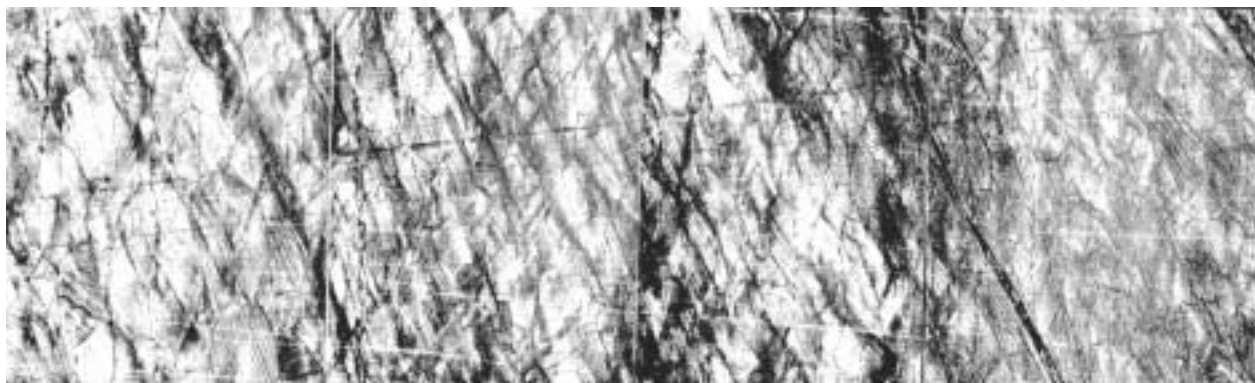
Рис. 1. Структура сплава ХН75ВМЮ после проникания плоской кумулятивной струи, \times 200
