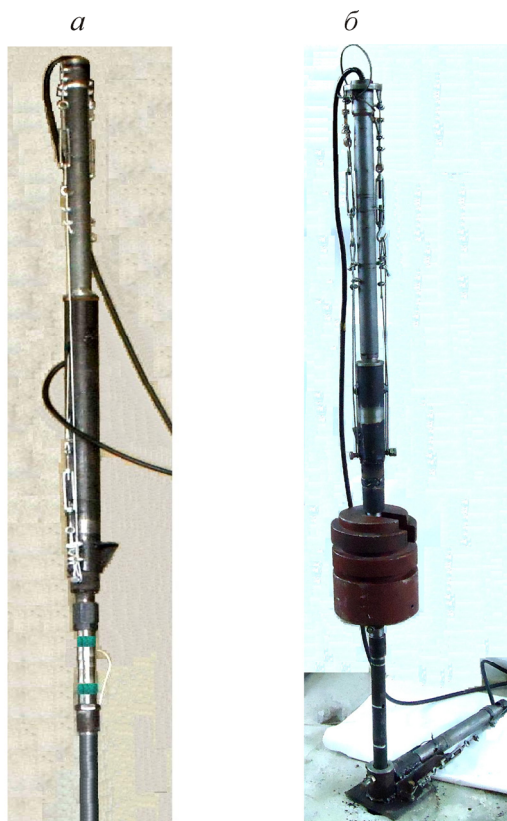
Рис. 4. Погружение трубы диаметром 33 мм пневмомолотами “Тайфун-2” и “Тайфун-1” с соосной компоновкой (а); пневмомолотами “Тайфун-2” и “Тайфун-1-2.4” при продольно-поперечной их установке (б)
