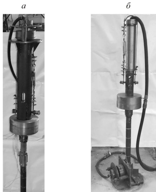
Рис. 3. Погружение трубы диаметром 50 мм пневмомолотом “Тайфун-4” и вибровозбудителем “Напор-01-05” с осевым (а) и поперечным (б) направлением колебаний
