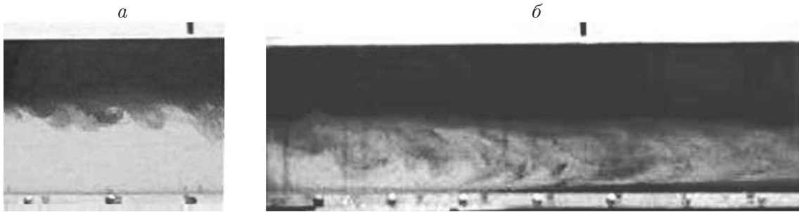
Рис. 2. Неустойчивость движения в опыте 2 (верхний бьеф, t = 36 с): а — в окрестности x = -70 см; б — в окрестности x = -3 см
