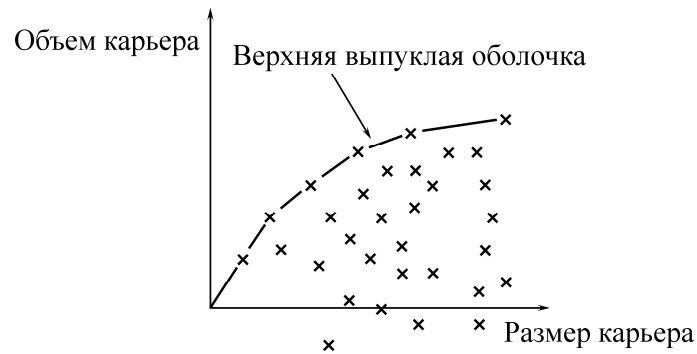
Рис. 8. Верхняя выпуклая оболочка кривой зависимости объема карьера от его размера
