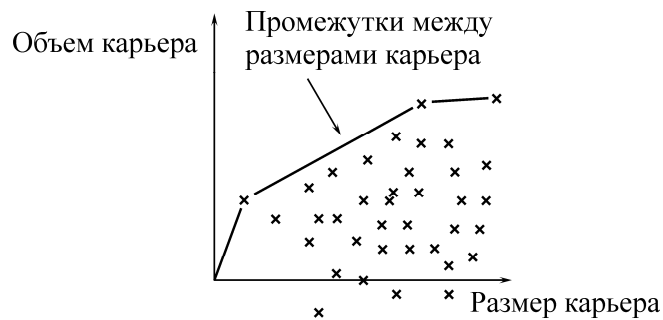
Рис. 9. Верхняя выпуклая оболочка кривой зависимости объема карьера от его размера показывает значительную разницу между возможными размерами карьера
