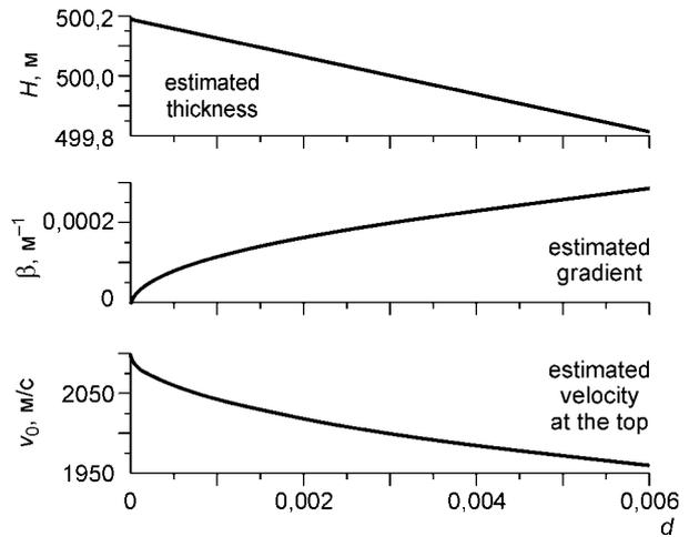
Рис. 2. Чувствительность полученных значений параметров к погрешности за счет неточности определения параметра  $d$ .
