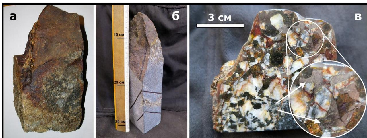
**Рис. 3.** Исходный образец минерализованного троктолита 13DV551-4а (а), продукт его распиловки с прожилком и “нашлепкой” (б) и демонстрационный образец пегматоидного троктолита с обильными сульфидами (в), выпиленный из верхушки образца на рис. 3б
