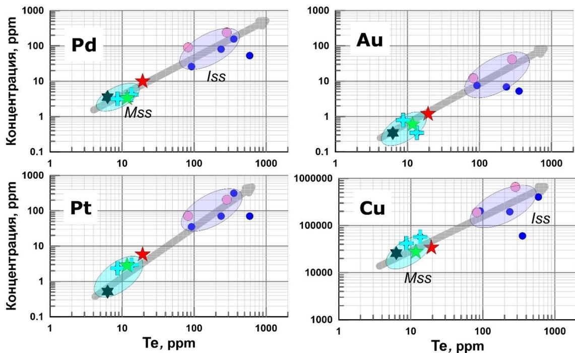
Рис. 12. Нормированные концентрации легких платиноидов, Au и Cu в зависимости от нормированного содержания теллура
