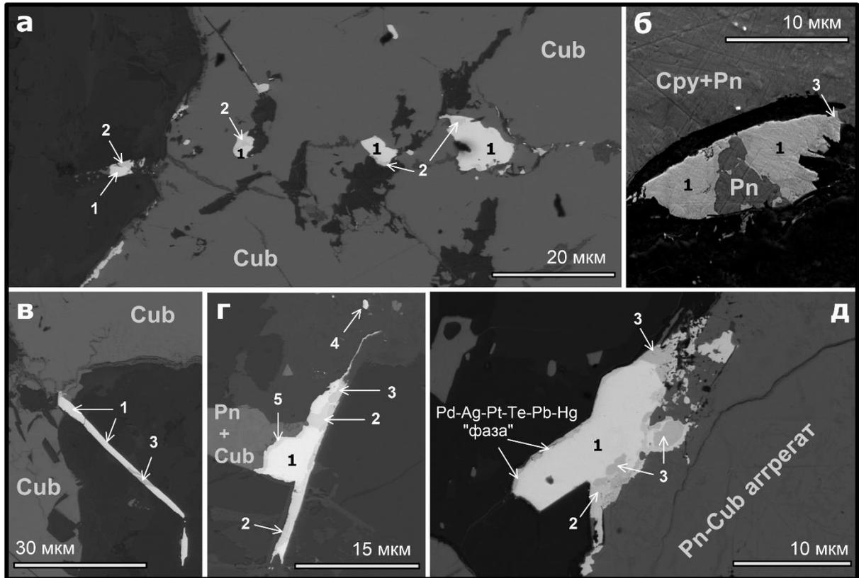
**Рис. 7.** Микроизображения ЭПГ-фаз в сульфидоносном троктолите из верхней части зоны Конникова (препараты 13DV554-1-3 и -12), полученные при помощи автоэлектронного эмиссионного микроскопа Hitachi SU-70 FESEM ультравысокого разрешения.
