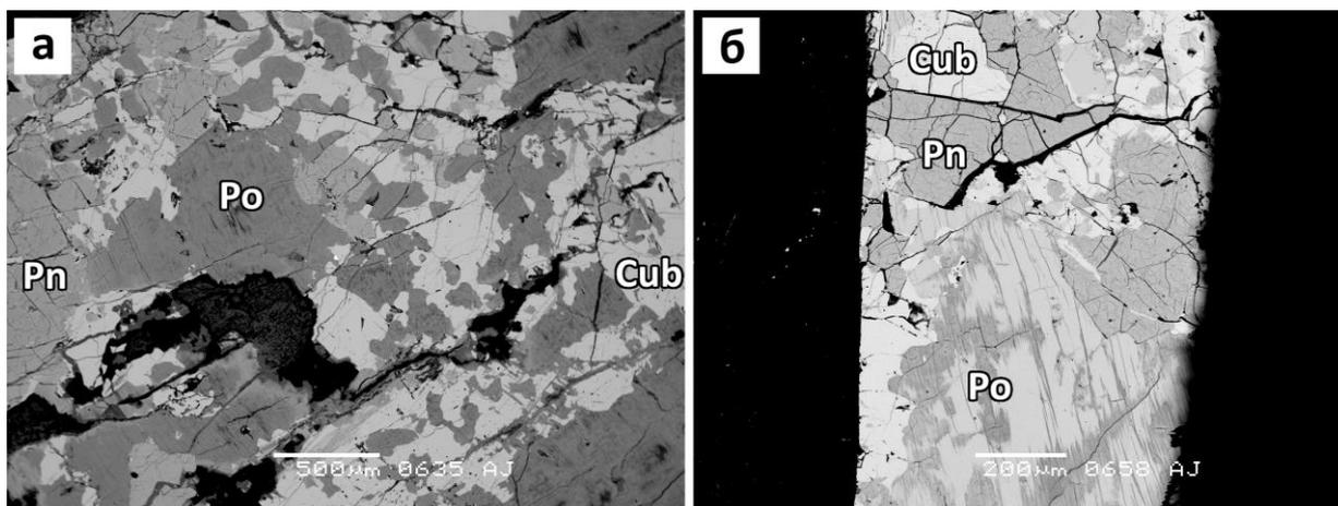
**Рис. 6.** Микроизображения сульфидов из пегматоидного троктолита 13DV551-4 (аншлиф 13DV551-4a-2d), в отраженных электронах
