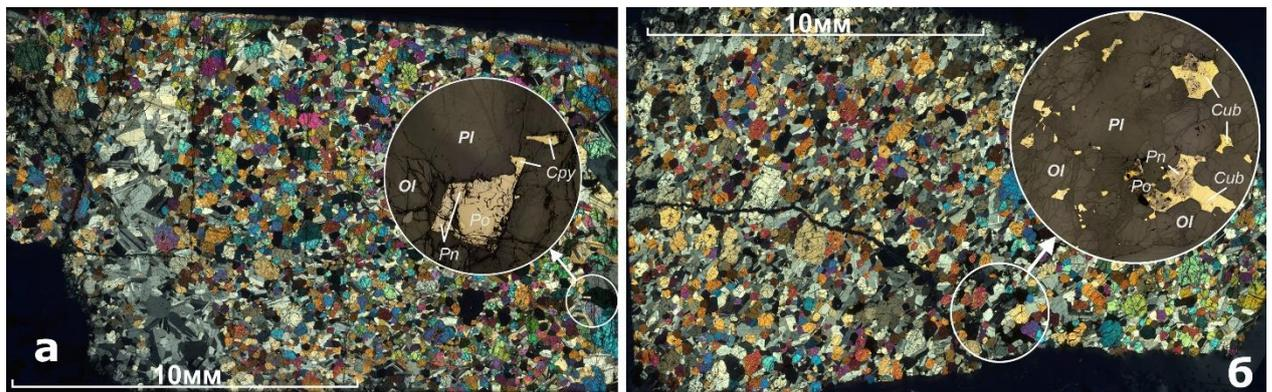
**Рис. 4.** Микроизображения сульфидоносных троктолитов в высоком разрешении, полученные путем сканирования шлифов с использованием поляризационных пленок
