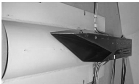
Рис. 2. Внешний вид пространственного воздухозаборника ПВРД.
