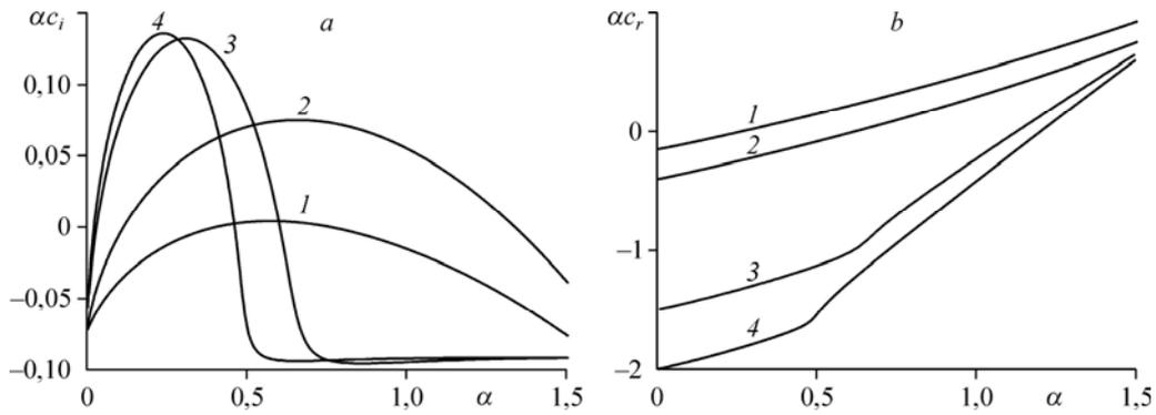
Рис. 3. Зависимости инкремента (а) и частоты колебаний (b) от волнового числа при  $Re = 200$  для различных значений параметра закрутки  $q$ .
