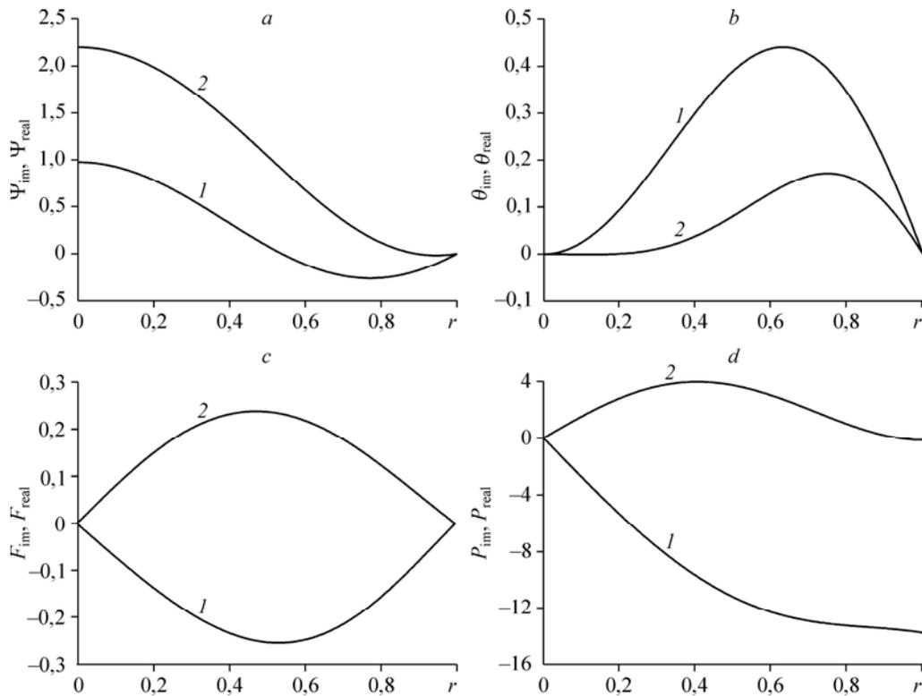
Рис. 2. Вещественные и мнимые части амплитудных функций  $\tilde{\psi}(r)$ ,  $\tilde{\theta}(r)$ ,  $\tilde{F}(r)$ ,  $P(r)$  при  $Re = 200$ ,  $\alpha = 0,007$ ,  $q = 0,4$ .
