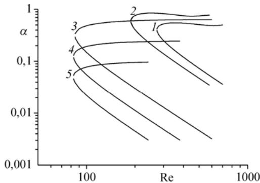
Рис. 4. Нейтральные кривые для различных значений параметра закрутки  $q$ .
