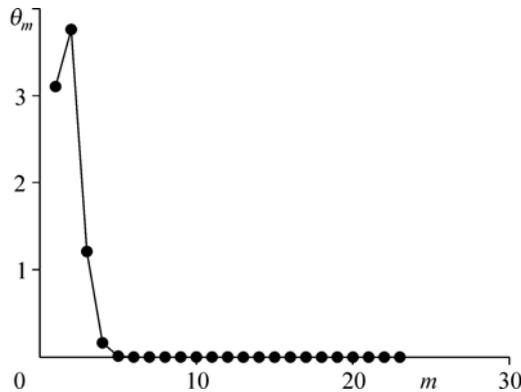
к изменению вычисленных значений фазовой скорости только в шестом десятичном знаке. На рис. 1 показана зависимость модуля коэффициента ряда Тейлора  $\theta_m$  от номера  $m$ . Наибольший вклад в сумму ряда дают члены с номером  $m < 6$ , а коэффициенты с номерами  $m > 45$  более чем на сто порядков меньше.
